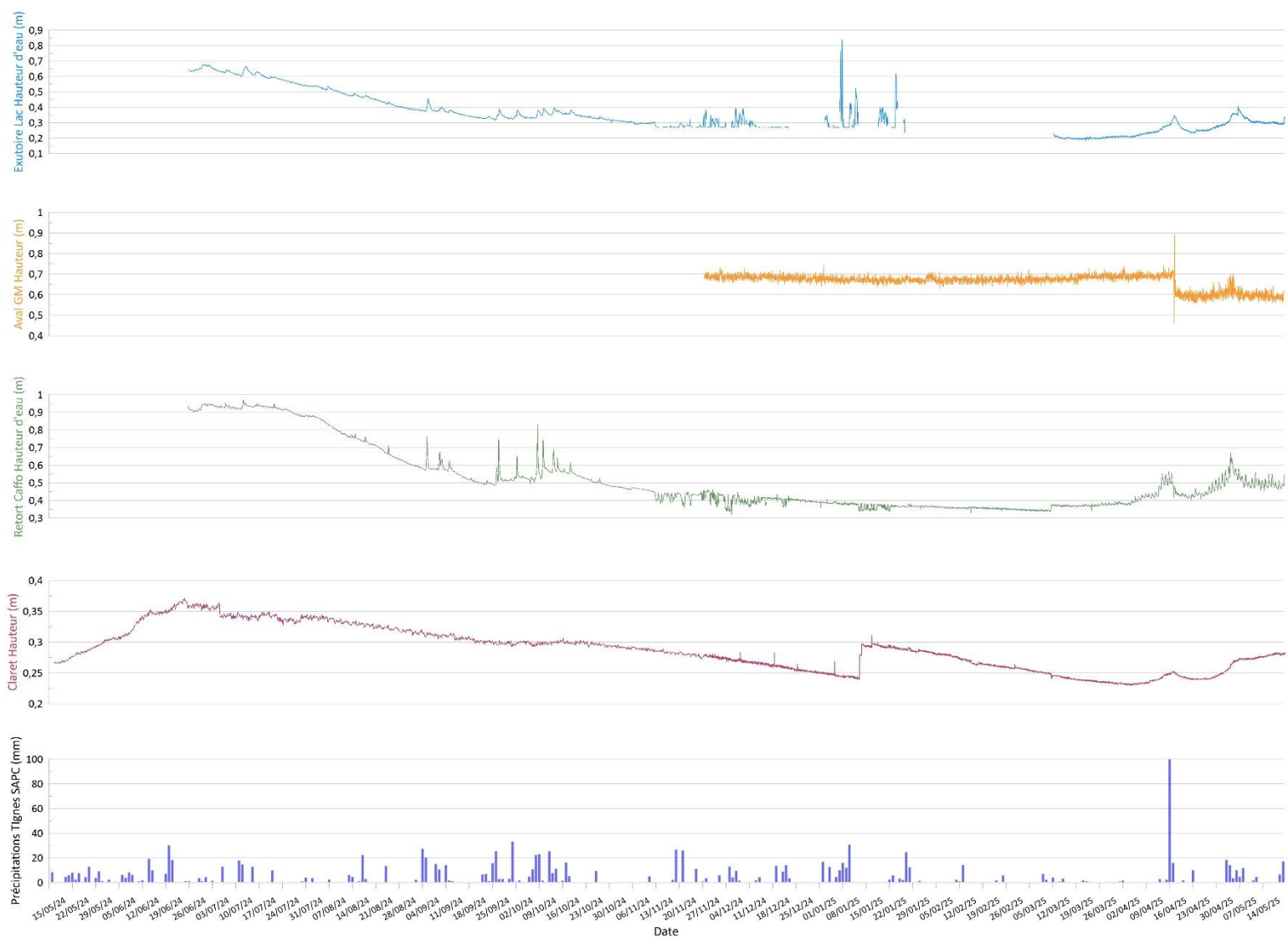
Figure 11: Mesures de hauteurs d'eau au niveau des 4 stations et pluviométrie journalière
