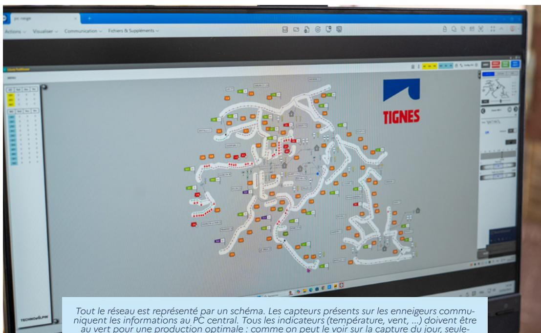
*Tout le réseau est représenté par un schéma. Les capteurs présents sur les enneigeurs communiquent les informations au PC central. Tous les indicateurs (température, vent, ...) doivent être au vert pour une production optimale : comme on peut le voir sur la capture du jour, seulement quelques secteurs remplissent les conditions.*
