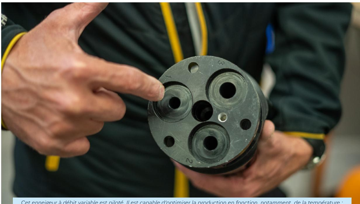
*Cet enneigeur à débit variable est piloté. Il est capable d'optimiser la production en fonction, notamment, de la température : un seul conduit au centre est suffisant pour l'air comprimé, alors que l'eau peut emprunter chacun des conduits extérieurs.*
